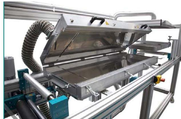
Abbildung 3: Trocknung mit Heißluft
