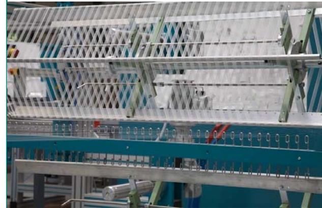
*Abbildung 5: Aufwicklung beschichteter Fäden mittels Garnweife*
