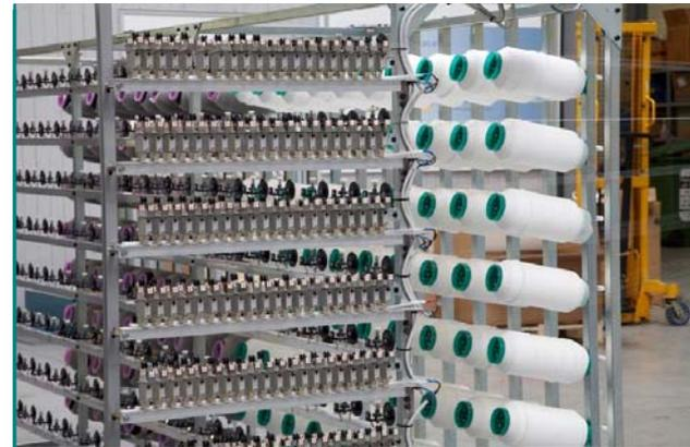
Abbildung 1: Abwickelgatter von Spulen in einer Fadenbeschichtungsanlage
