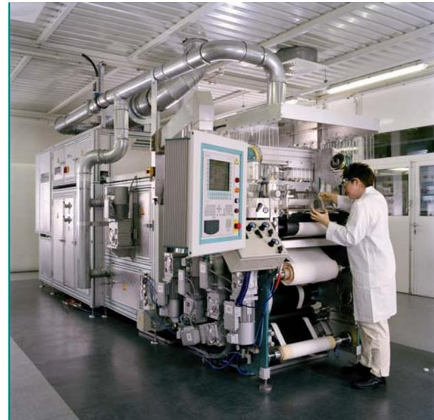
*Beschichtungsanlage Coatema Deskcoater mit einer Arbeitsbreite von 500 mm. Durch die Umlenkung im Trockner wird auf kleinstem Raum eine Trocknerlänge von 3.000 mm und eine Bedienbarkeit von nur einer Person geschaffen.*
