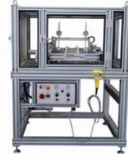
Laboranlage - Easycoater: zur diskontinuierlichen Herstellung von DIN A 4 Mustern
