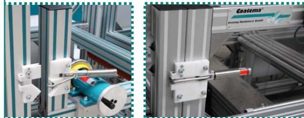
Click&Coat: die Anlagenkomponenten können durch "klicken" in die richtige Position gebracht werden
